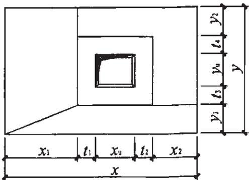
图 2.3.3-9 坡形截面杯口独立基础原位标注 (二)
