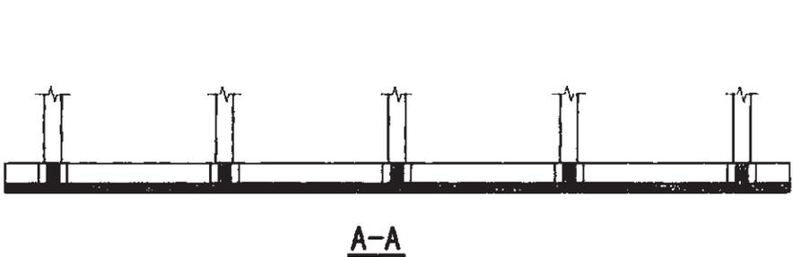
梁板式筏形基础平板LPB标注图示 图集号 11G101-3
