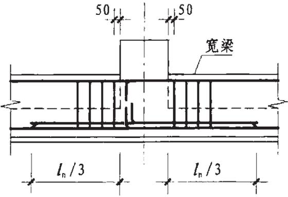
支座两边梁宽不同钢筋构造
