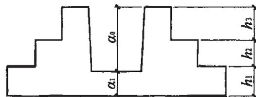
图 2.3.2-4 阶形截面杯口独立基础竖向尺寸(一)
