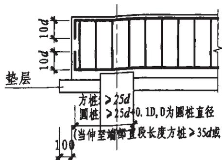
承台梁端部钢筋构造
