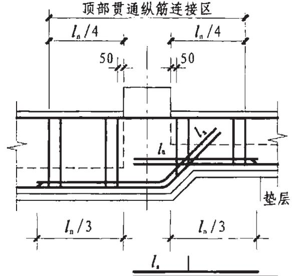
梁底有高差钢筋构造
