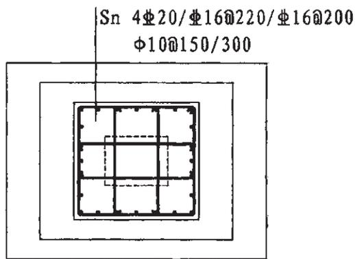
图 2.3.2-13 高杯口独立基础杯壁配筋示意
