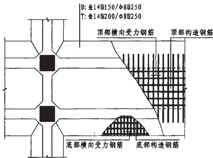
图 3.5.2-4 双梁条形基础底板顶部配筋示意
