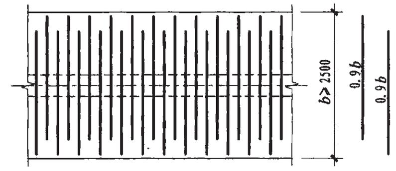
条形基础底板配筋长度减短10%构造
