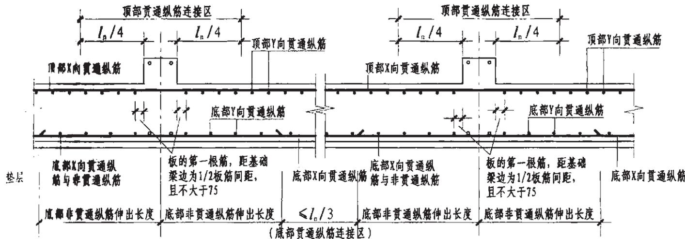
注：基础平板同一层面的交叉纵筋，何向纵筋在下，何向纵筋在上，应按具体设计说明。
