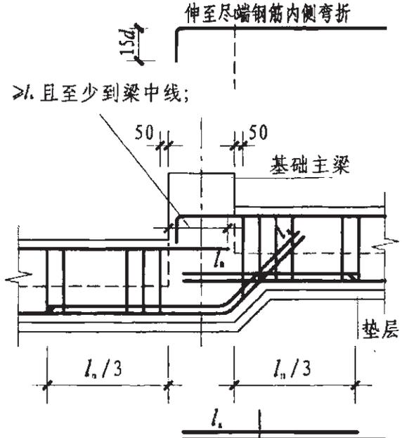
梁底、梁顶均有高差钢筋构造
