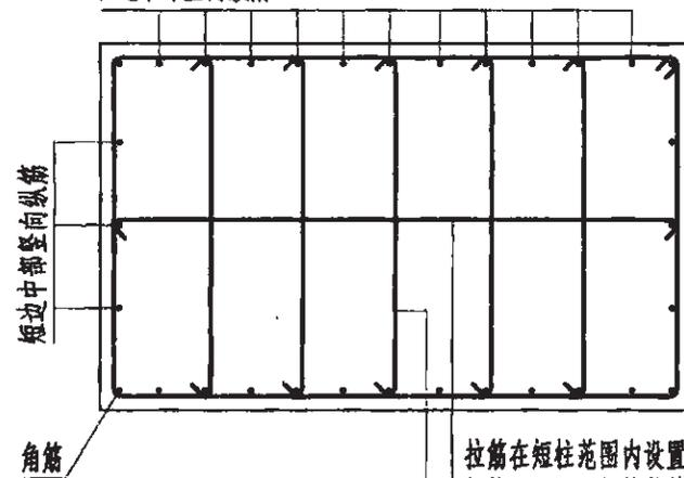
拉筋在短柱范围内设置, 其规格、间距同短柱箍筋, 双向相对于短柱纵筋隔一拉一
