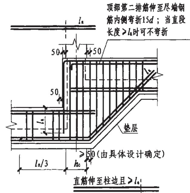
梁底、梁顶均有高差钢筋构造
