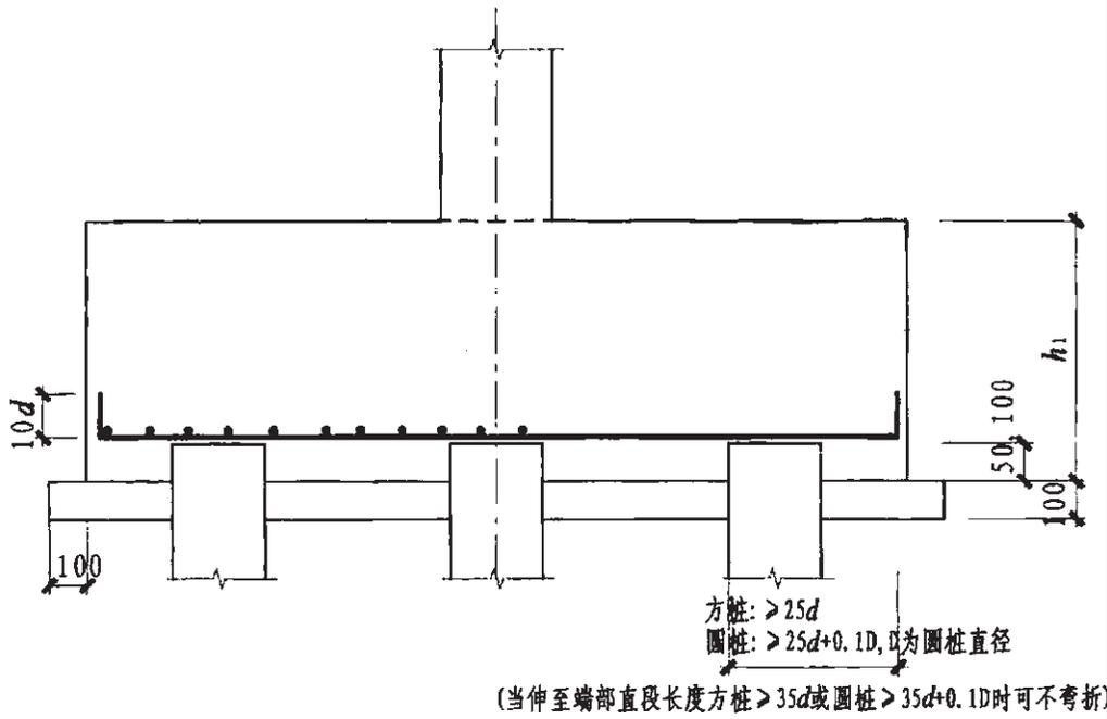
注: 1. 当桩直径或桩截面边长 < 800mm 时, 桩顶嵌入承台 50mm; 当桩径或桩截面边长 > 800mm 时, 桩顶嵌入承台 100mm。
