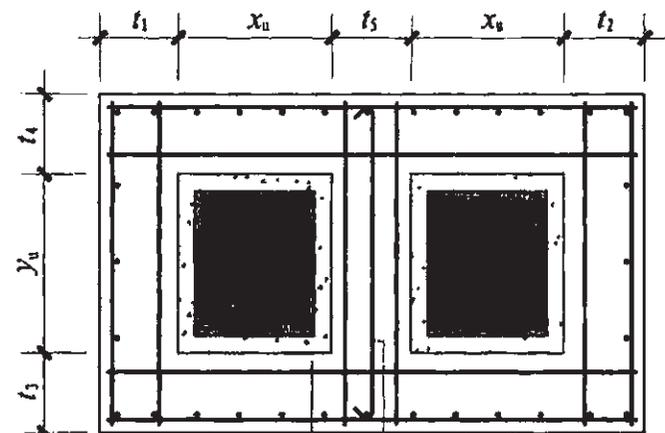
杯口顶部焊接钢筋网, 其下方外围为杯口范围设置的箍筋
