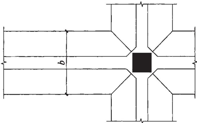
图 3.5.3 条形基础底板平面尺寸原位标注
