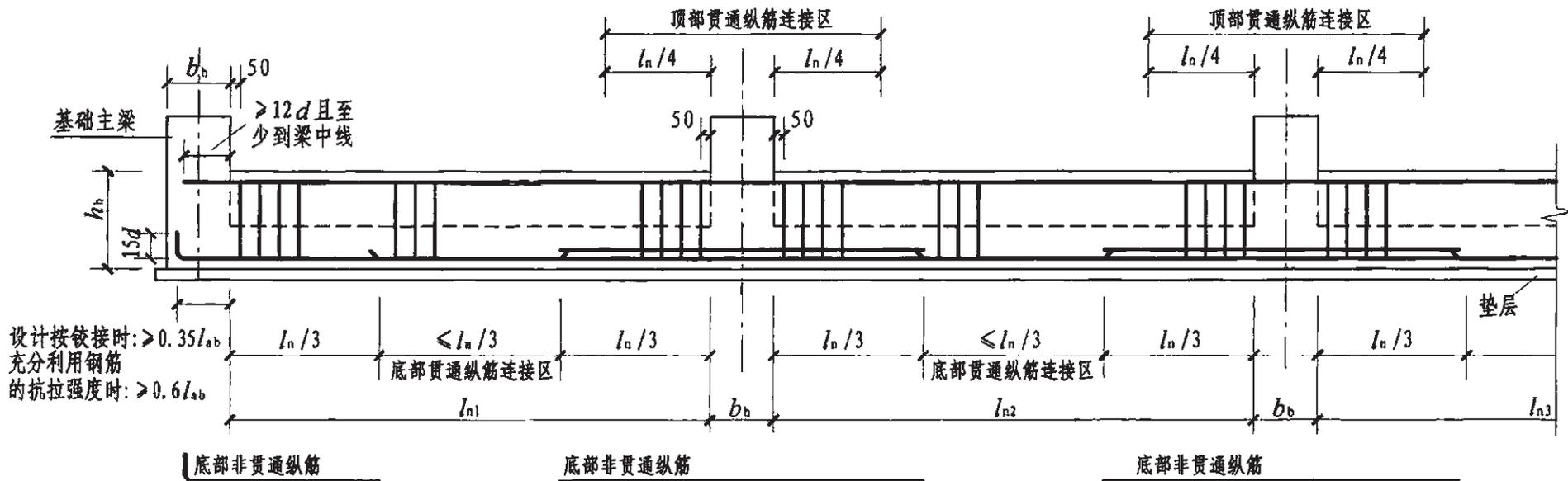
底部贯通纵筋，在其连接区内搭接、机械连接或对焊连接。同一连接区段内接头面积百分率不应大于50%。当钢筋长度可穿过一连接区到下一连接区并满足要求时，宜穿越设置
