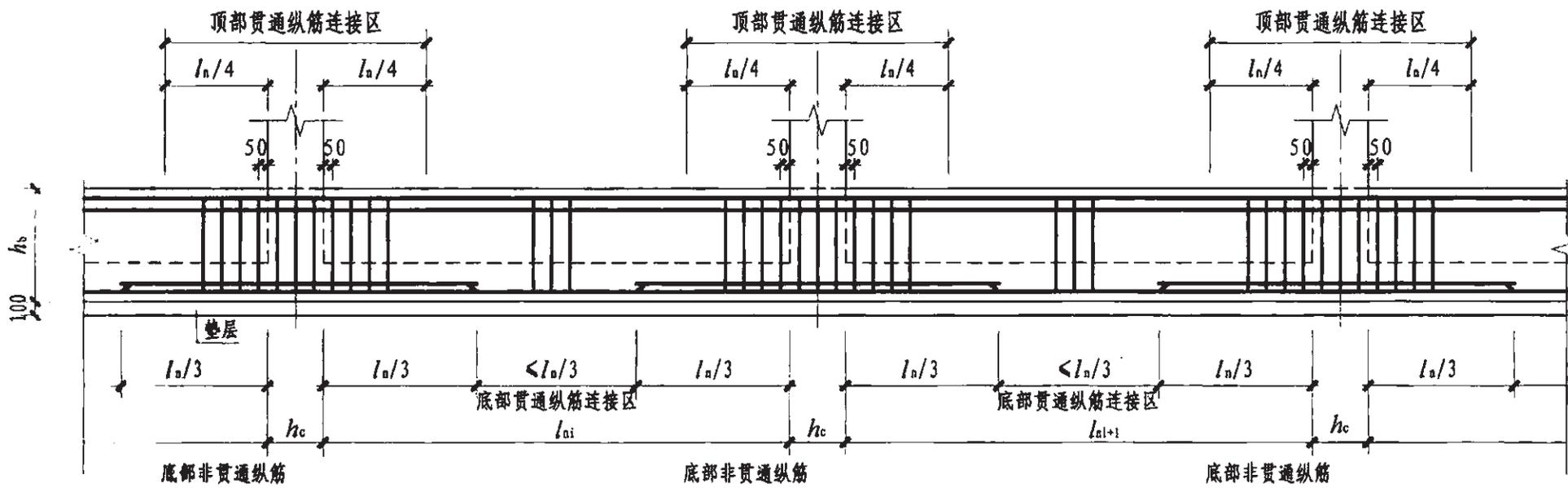
底部贯通纵筋在其连接区内采用搭接、机械连接或焊接。同一连接区段内接头面积百分率不宜大于50%。当钢筋长度可穿过一连接区到下一连接区并满足连接要求时，宜穿越设置
