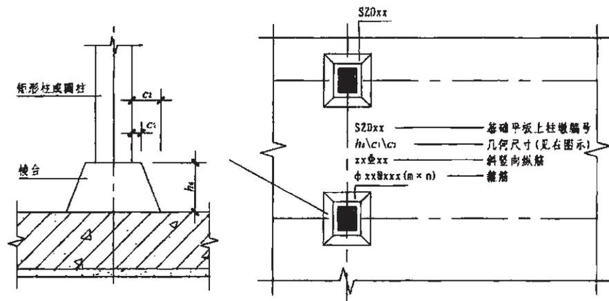
图 7.2.3-1 棱台形上柱墩引注图示
