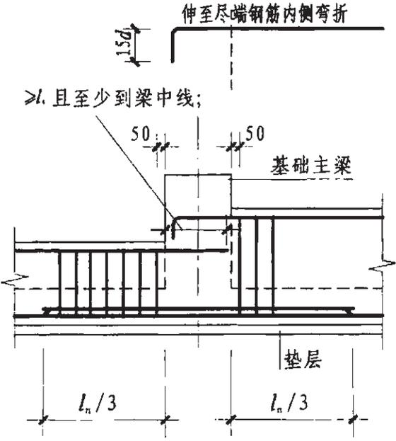
梁顶有高差钢筋构造
