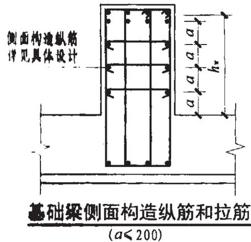
基础梁侧面构造纵筋和拉筋
