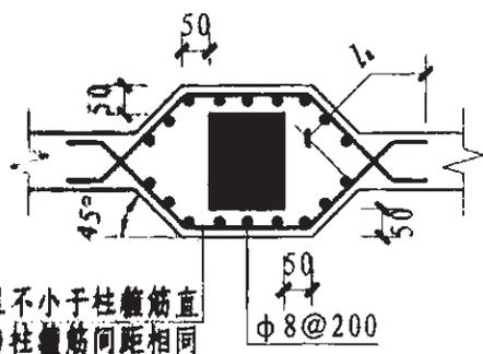
**基础梁中心穿柱侧腋构造**
