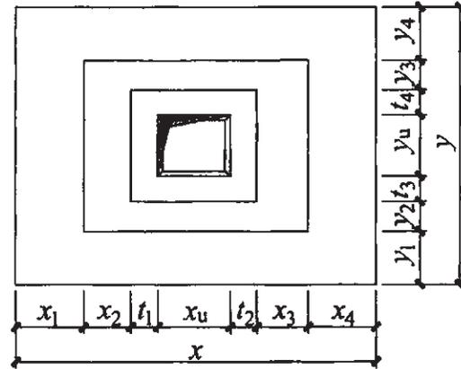
图 2.3.3-6 阶形截面杯口独立基础原位标注 (一)
