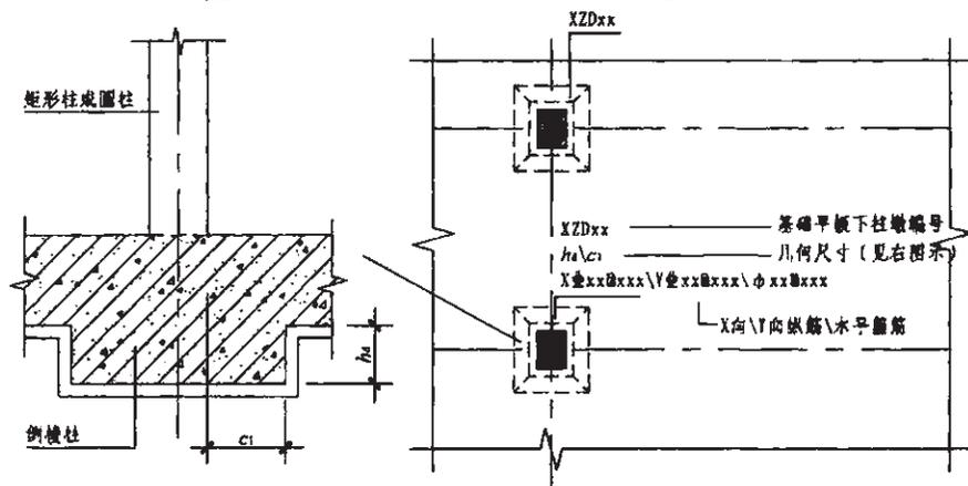
图 7.2.4-2 棱柱形下柱墩引注图示
