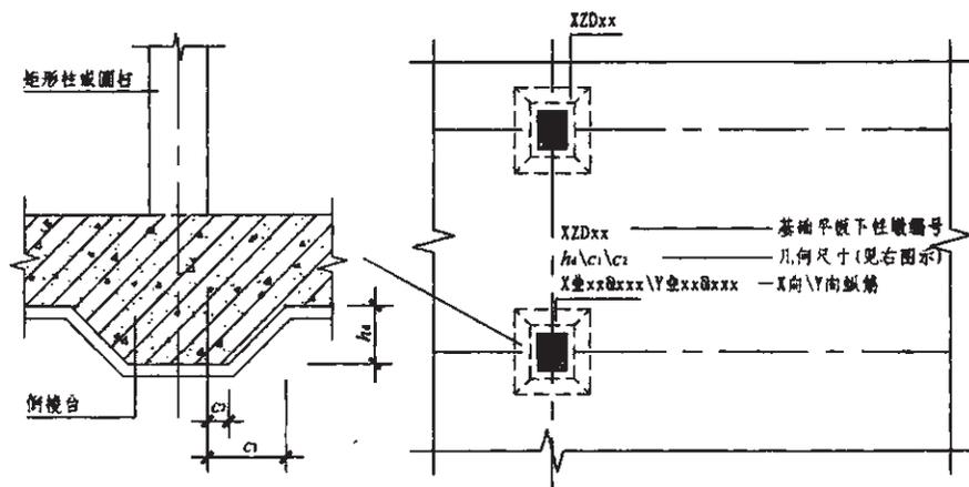
图 7.2.4-1 棱台形下柱墩引注图示
