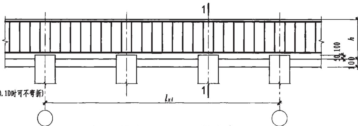
墙下双排桩承台梁CTL钢筋构造
