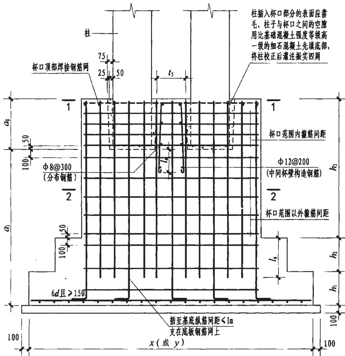
双高杯口独立基础杯壁和基础短柱配筋构造
