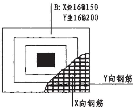
图 2.3.2-10 独立基础底板底部双向配筋示意
