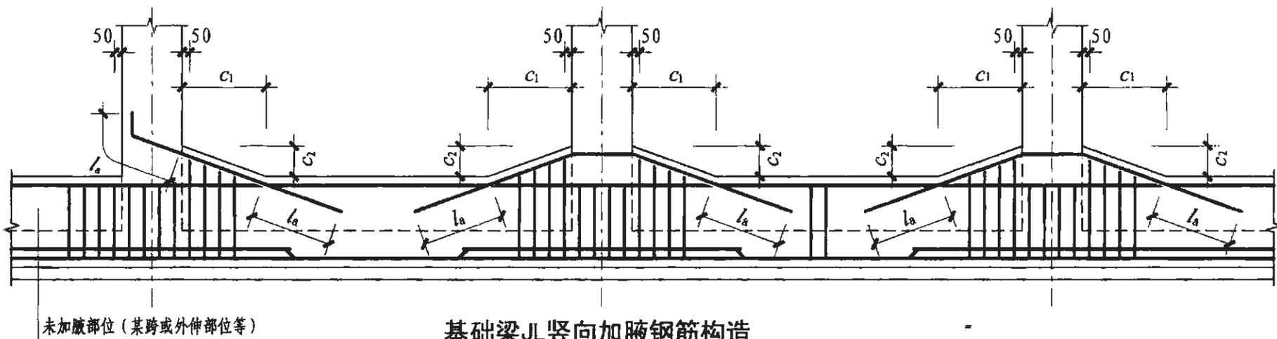
基础梁JL竖向加腋钢筋构造
