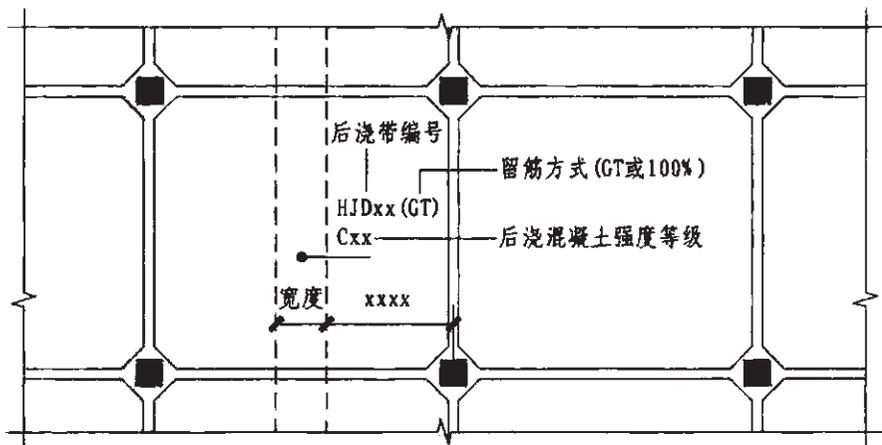
图 7.2.2 后浇带 HJD 引注图示
