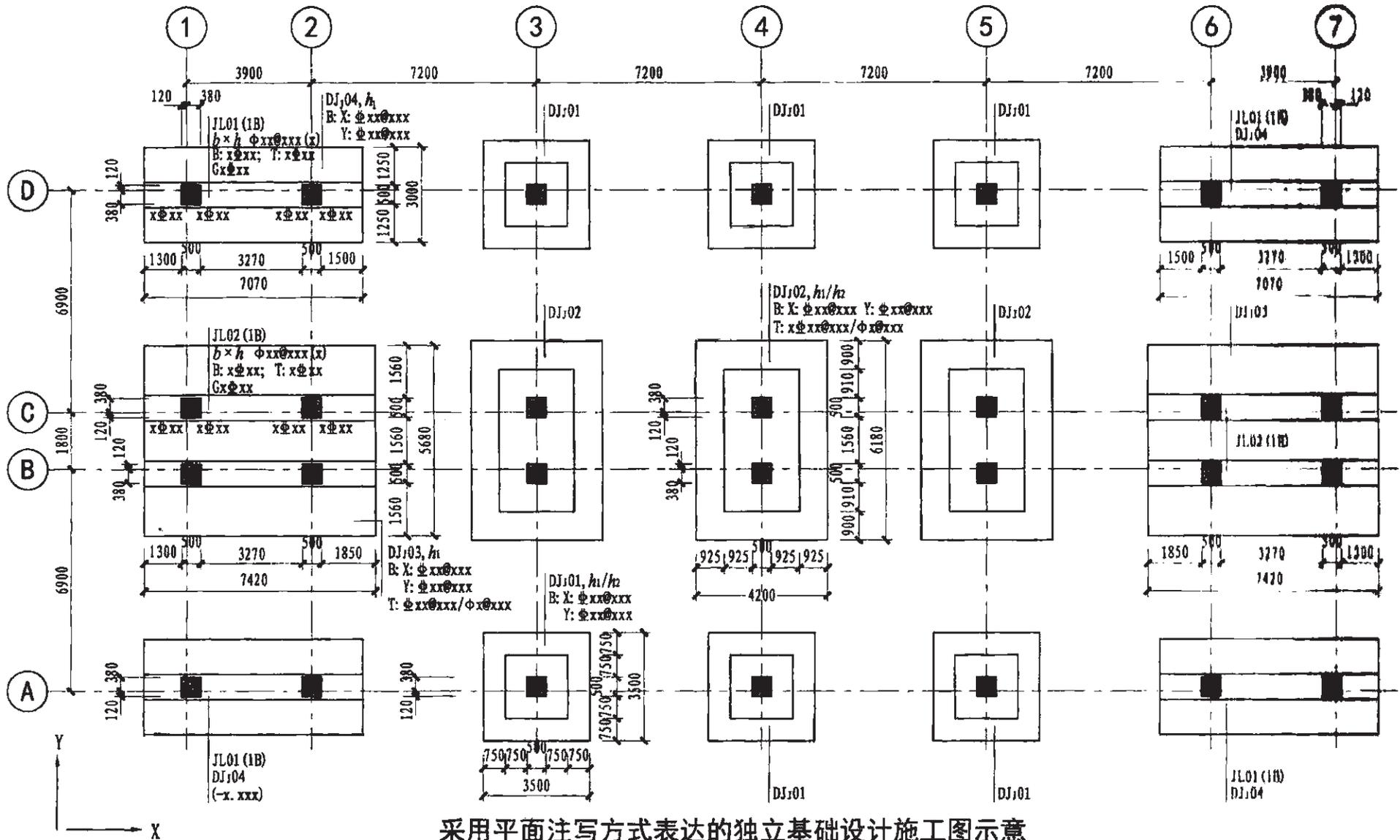
采用平面注写方式表达的独立基础设计施工图示意
