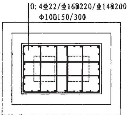
图 2.3.2-14 双高杯口独立基础杯壁配筋示意
