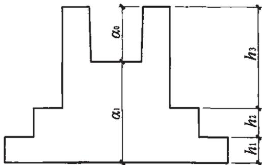
图 2.3.2-6 阶形截面高杯口独立基础竖向尺寸 (一)
