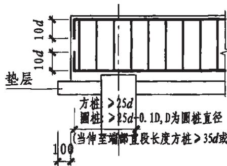
承台梁端部钢筋构造
