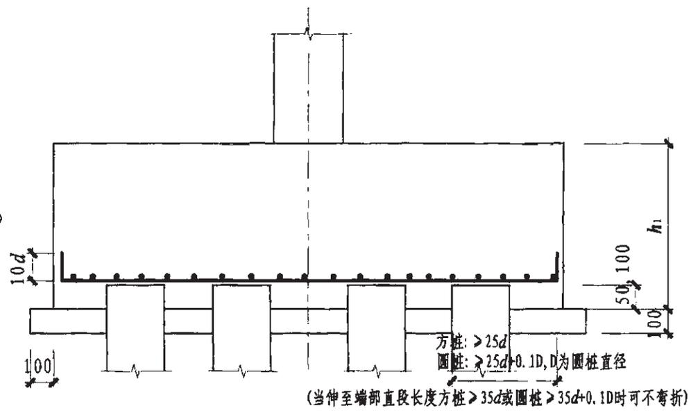
注: 1. 当桩直径或桩截面边长  $< 800\text{mm}$  时, 桩顶嵌入承台  $50\text{mm}$ ; 当桩径或桩截面边长  $\geq 800\text{mm}$  时, 桩顶嵌入承台  $100\text{mm}$ 。
