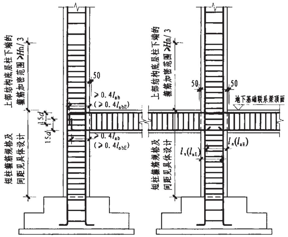
基础联系梁JLL配筋构造（二）
