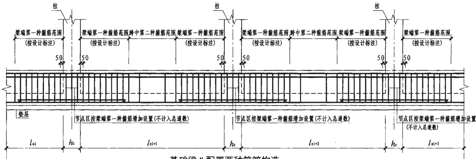
基础梁JL配置两种箍筋构造
