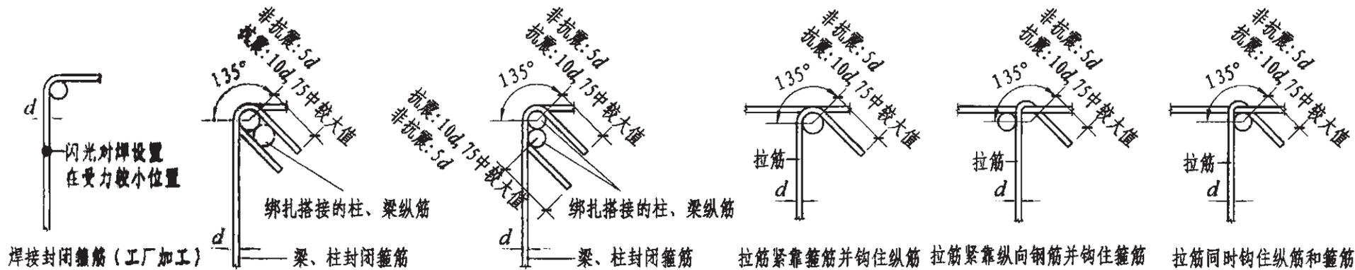
焊接封闭箍筋 (工厂加工)
