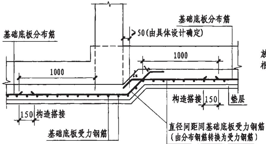
条形基础底板板底不平构造 (一)
