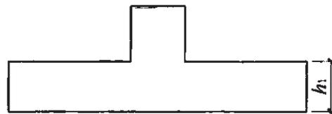
图 3.5.2-2 条形基础底板阶形截面竖向尺寸
