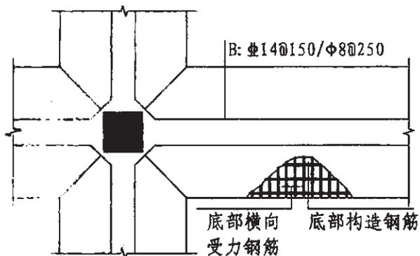
图 3.5.2-3 条形基础底板底部配筋示意
