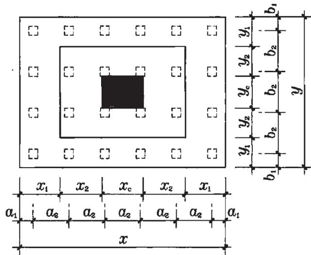
图 6.3.3-1 矩形独立承台平面原位标注
