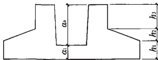
图 2.3.2-8 坡形截面杯口独立基础竖向尺寸
