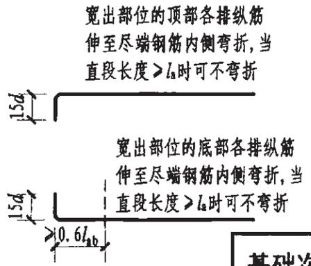
宽出部位的顶部各排纵筋伸至尽端钢筋内侧弯折,当直段长度 $>l_n$ 时可不弯折
