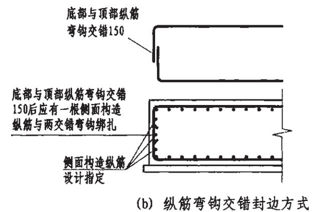
**板边缘侧面封边构造**
