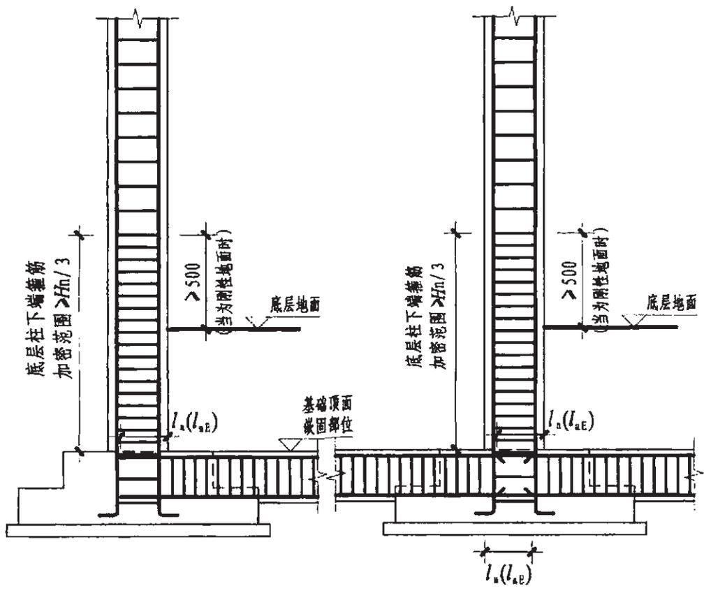
基础联系梁JLL配筋构造（一）
