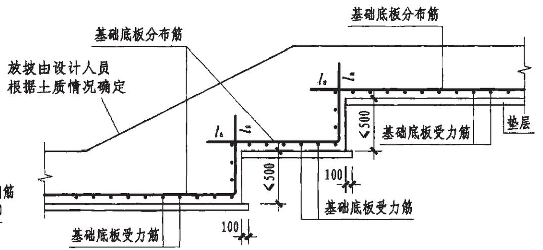
条形基础底板板底不平构造 (二)
