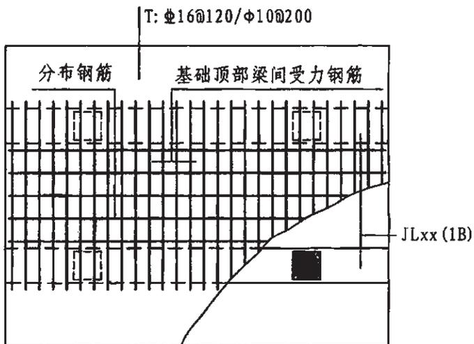
图 2.3.6-3 四柱独立基础底板顶部基础梁间配筋注写示意
