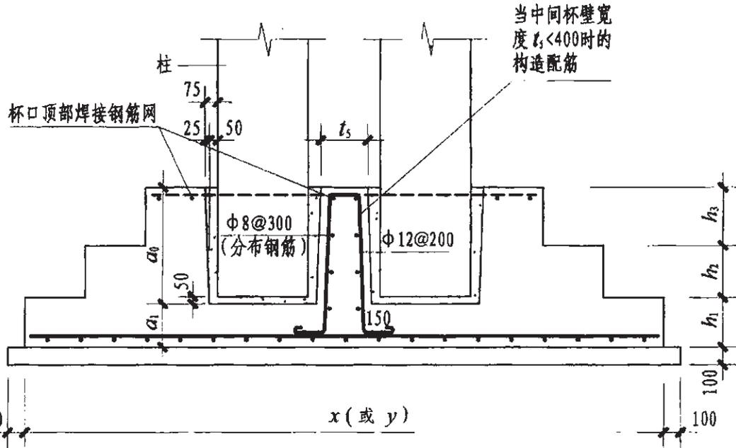
杯口独立基础构造
