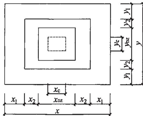
图 2.3.3-3 设置短柱独立基础的原位标注
