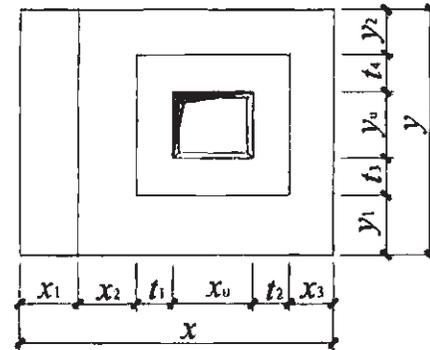
图 2.3.3-7 阶形截面杯口独立基础原位标注 (二)
