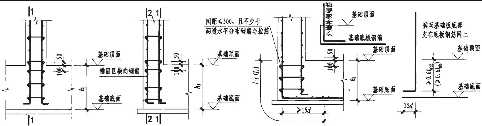
墙插筋在基础中锚固构造(一)
