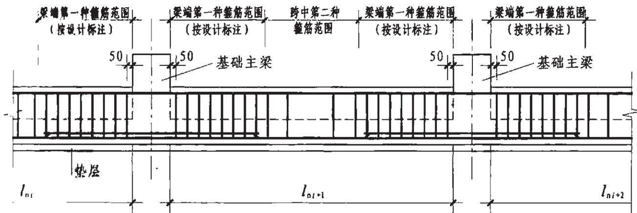
**基础次梁JCL配置两种箍筋构造**
