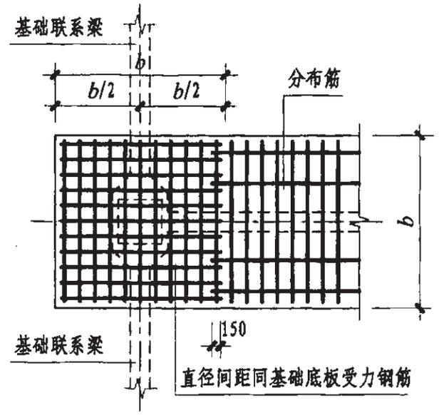
条形基础无交接底板端部构造
