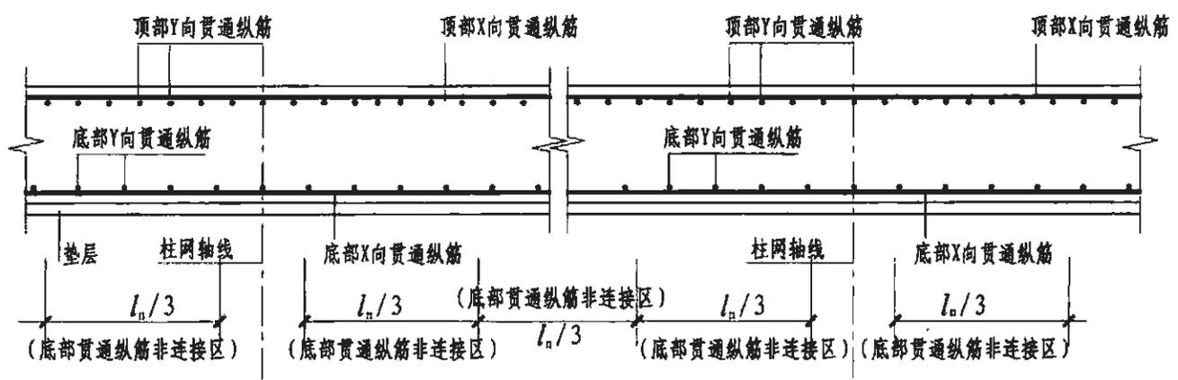
平板式筏形基础平板BPB钢筋构造 (跨中区域)
