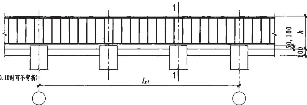
墙下单排桩承台梁CTL钢筋构造
