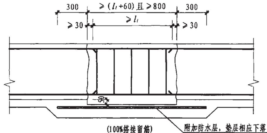
基础底板后浇带HJD构造
