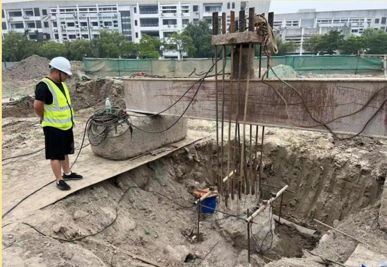
⇐ 工程检测桩抗拔试验。
