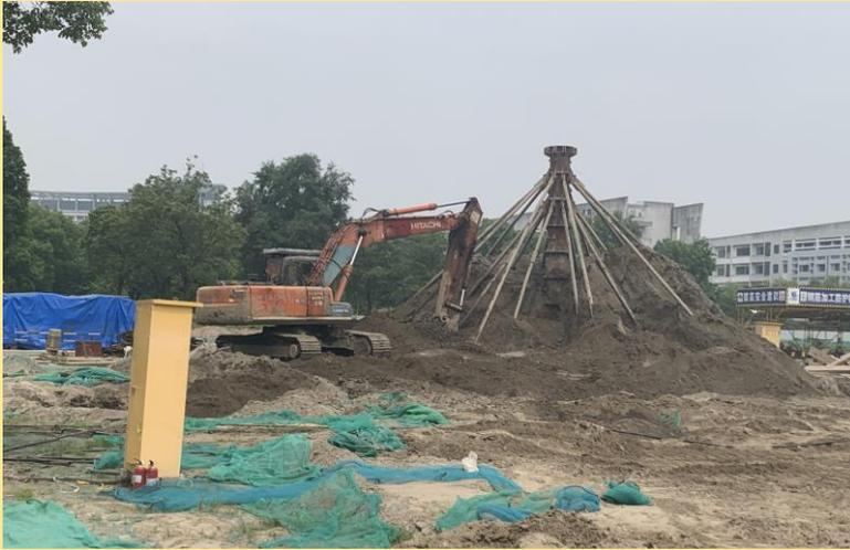
⇐ 工程检测桩静载试验。
